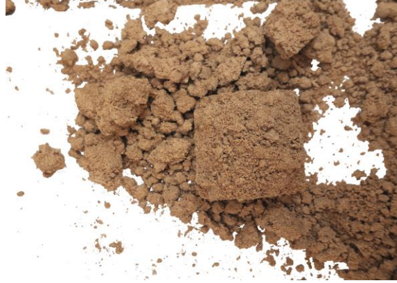
Şekil 4. % 70 NTT ile hazırlanan kompozitte matris miktarının numune bütünlüğünü korumada yetersiz kalması
