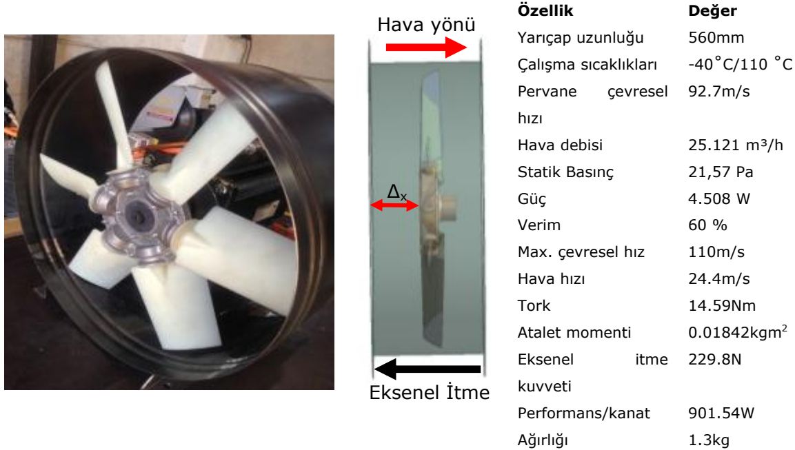
Şekil 2. Fan modeli ve modele ait teknik değerler
