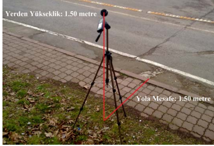
Şekil 4. Ses basınç düzeyi ölçerin ölçüm sırasındaki konumu
