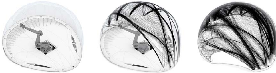
Şekil 11. Pnömatik membran içerisinde robot kolu ile karbon fiberli üretim [URL-4]
